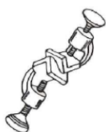
Mufa: Suporte para a garra de condensador.
