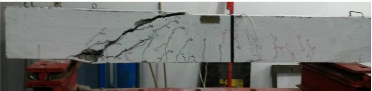
c) Viga após o ensaio
