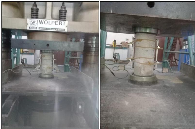
**Figura 3.17 - Ensaio de módulo de elasticidade.**
