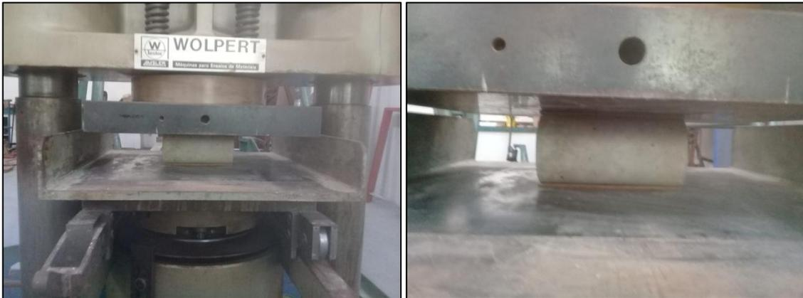
**Figura 3.16 - Ensaio de compressão diametral.**
