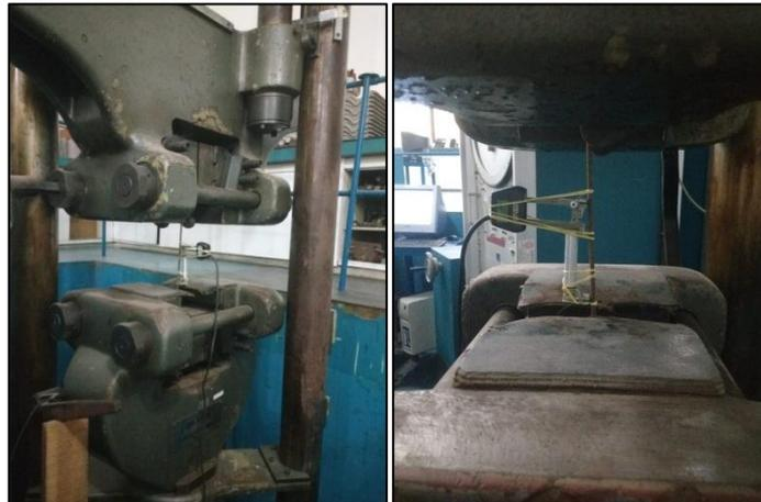
**Figura 3.18 - Ensaio a tração das armaduras.**
