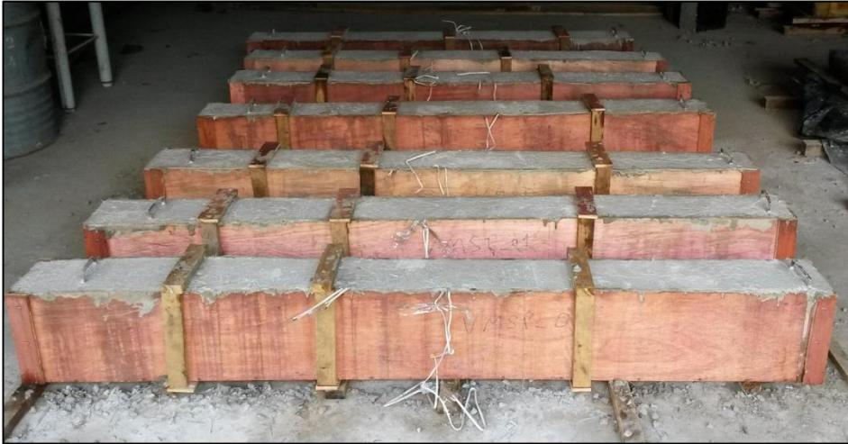
**Figura 3.13 - Vigas concretadas com os extensômetros.**
