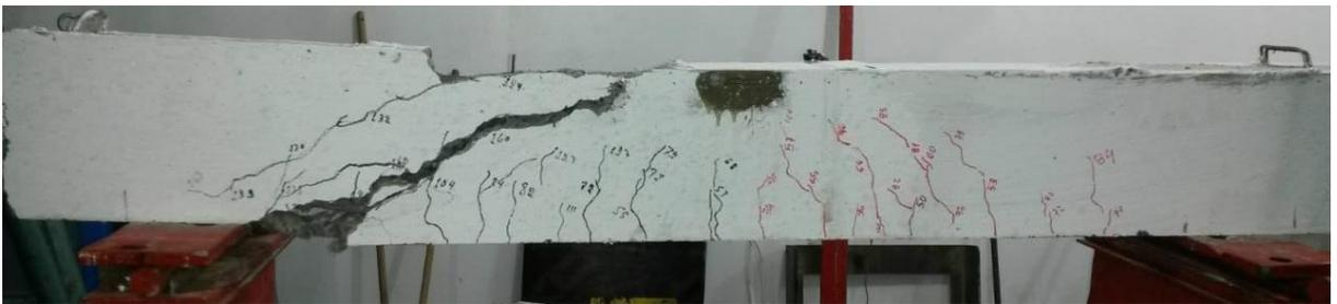
c) Viga após o ensaio
