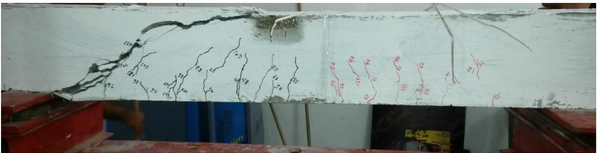
c) Viga após o ensaio
