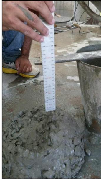
**Figura 3.11 - Ensaio de Slump Test.**
