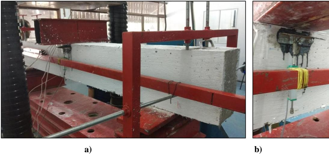
**Figura 3.8 - a) Viga com o potenciômetro fixado ao Yoke b) O Potenciômetro posicionado na chapa metálica.**
