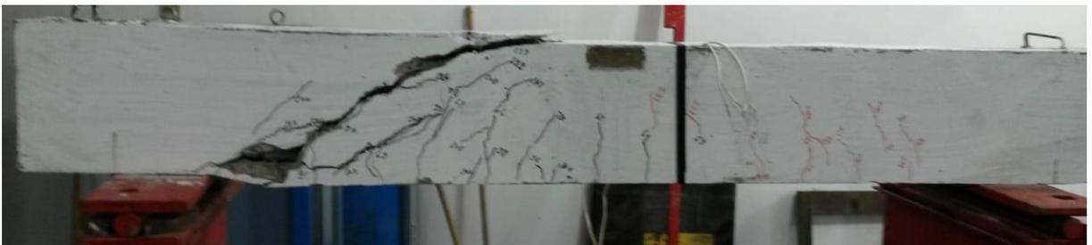
c) Viga após o ensaio
