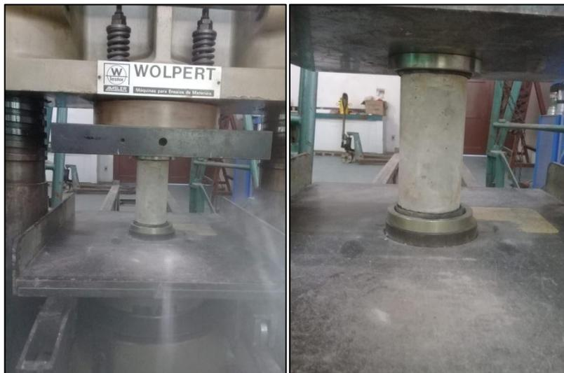
Figura 3.15 - Ensaio de compressão.
