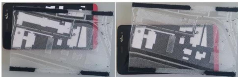
Figura 53: Mapas impressos em 3D com os marcadores capacitivos sobrepostos à tela do dispositivo.
