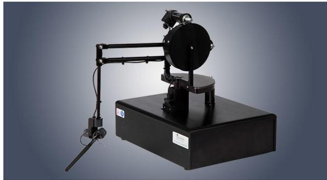
Figura 40: *PHANTOM force-feedback*
