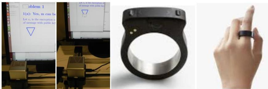
Figura 49: Mini *Hyperbraille* com eixos XY (Esquerda) e anel de feedback háptico (direita)
