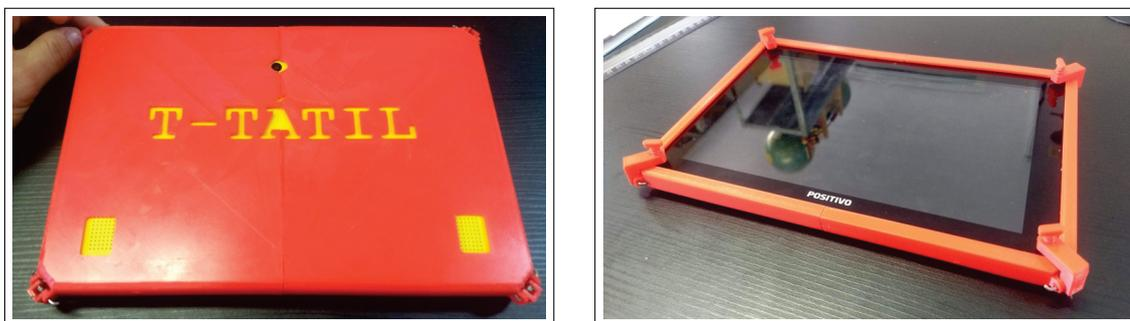
Figura 28 – Capinha impressa e colocada no *tablet*
