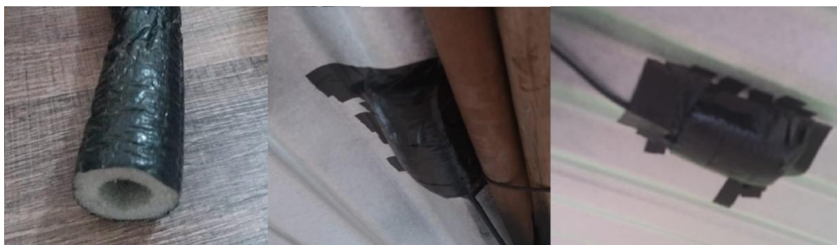
Figura 3.13 - Materiais de métodos de acomodação do sensor DS18B20 à telha Fonte: O Autor
