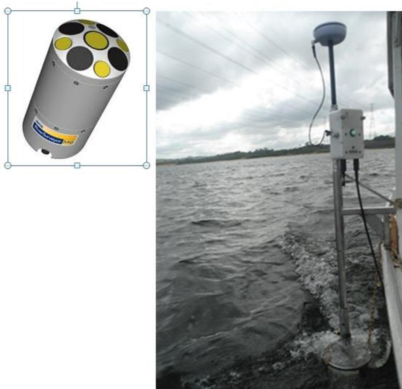
Figura 9 – ADCP fora de uso e embarcada em medição no rio Tocantins.
