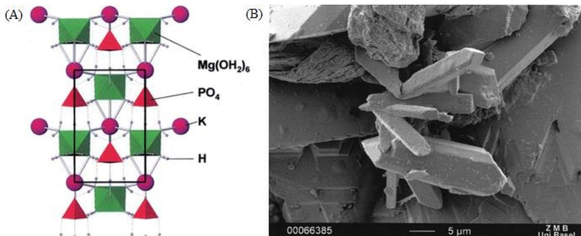
**Figura 3.7** - (A) Estrutura cristalina da K-estruvita, projetada ao longo do plano [010], exibindo ligações de hidrogênio H-O e a presença de potássio substituindo o nitrogênio e (B) imagem MEV de K-estruvita de ocorrência natural em Lengenbach na Suíça. Fonte: Graeser et al. (2008).
