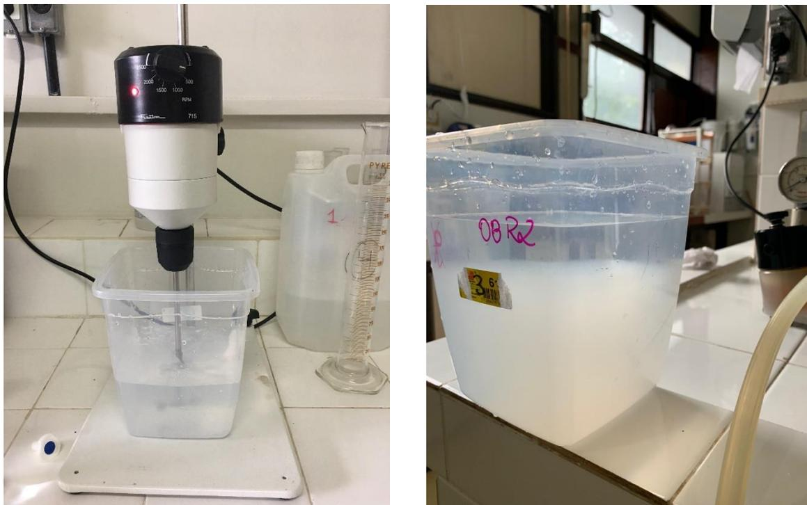
**Figura 4.3** – Agitador utilizado nos ensaios e solução de síntese em repouso
