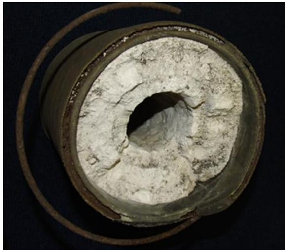
**Figura 3.3** - Estruvita formada na parte interna da tubulação da estação de tratamento de águas residuais. Fonte: MacAdam & Jarvis (2015).
