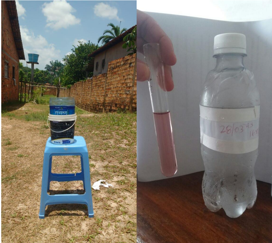
Figura 12- Coletor para amostras de água de chuva e amostra de água de chuva Fonte: O autor.
