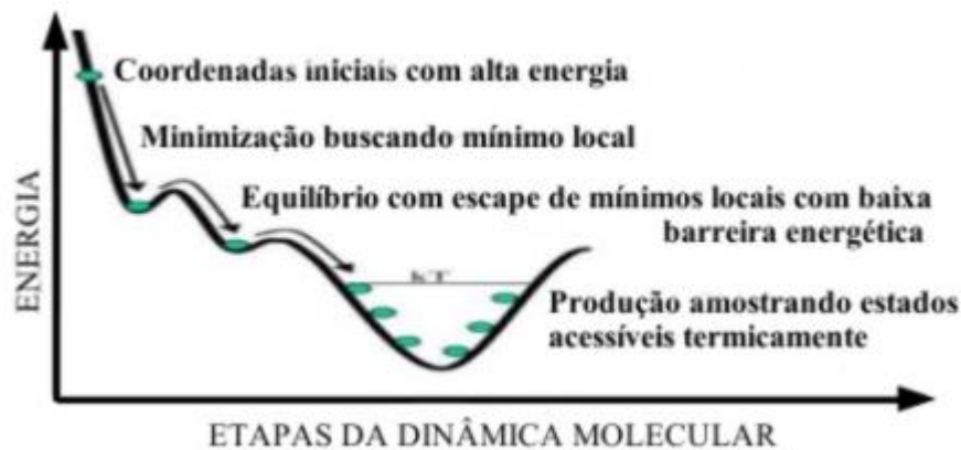
Figura 8: Efeito de cada etapa da MD sobre a energia e seu objetivo principal. Fonte: Adaptado de SIANI, P. Simulação por Dinâmica Molecular Modelagem e Aplicações em Terapia Fotodinâmica
