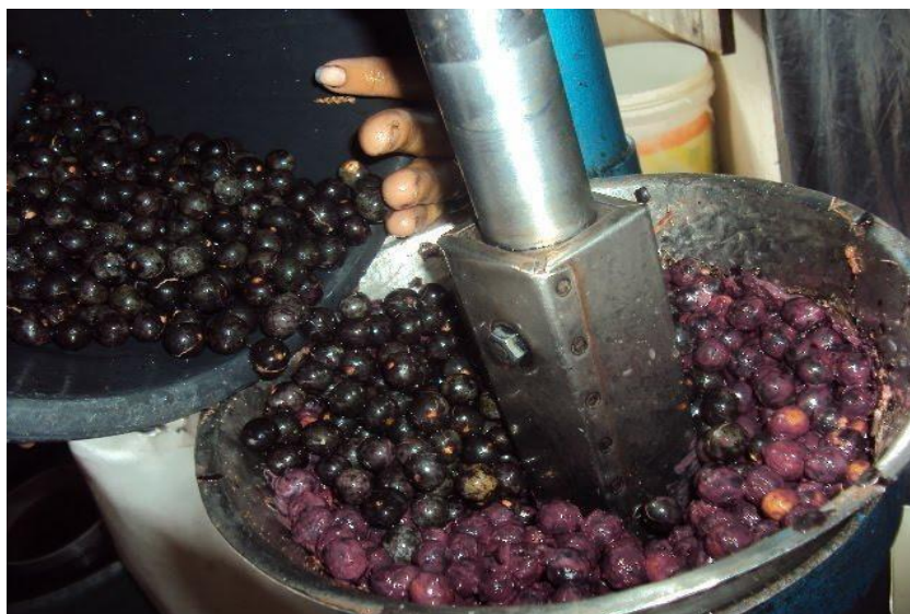
Figura 3 – Máquina para separar o caroço da casca
