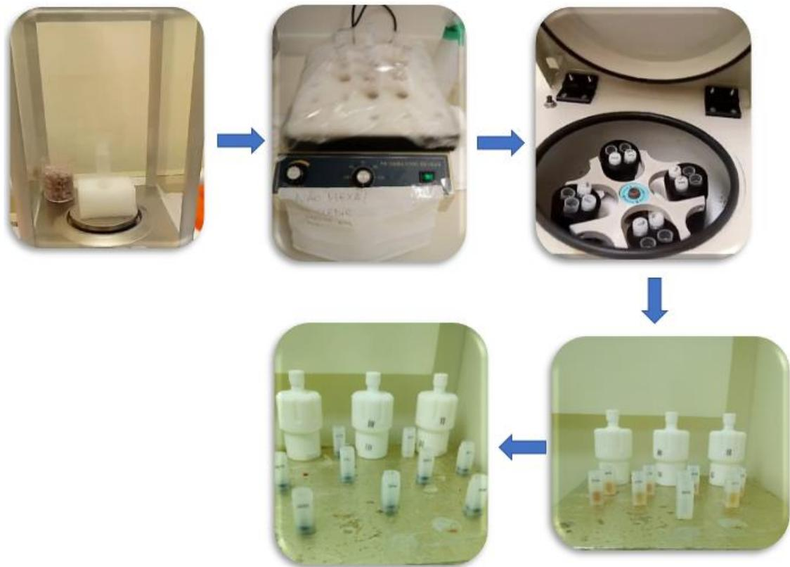
Figura 14 - Etapas da lixiviação das amostras de sedimento de fundo, MPS e Casco + tinta.
