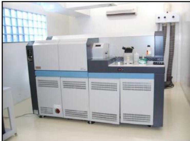
Figura 17 - Espectrômetro de massa com fonte plasma ICP-MS Thermo Finnigan, modelo Neptune do Laboratório Pará-Iso. Fonte: Oliveira (2016).
