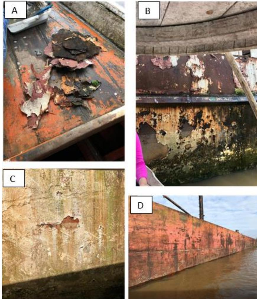
Figura 10 - Exposição de embarcações com tintas anti-incrustantes e fragmentos de tinta na baía do Guajará e rio Maguari. A: Fragmentos de embarcações; B: Casco de navio com tinta anti-incrustante e com incrustação; C: Embarcação em estado deterioramento; D: Embarcação abandonada.
