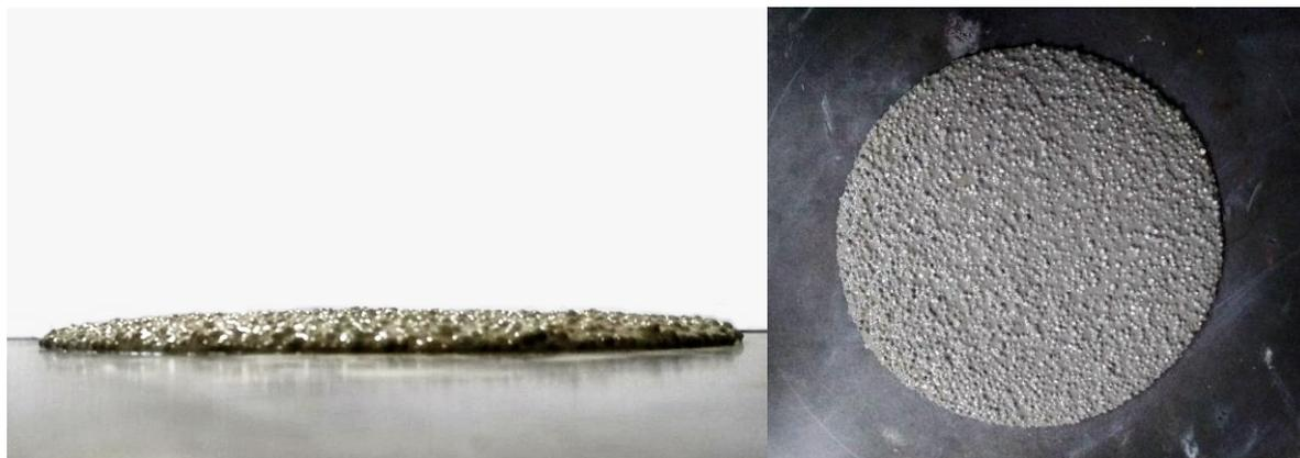
**Figura 3.6 – Determinação do índice de consistência da argamassa leve.**
