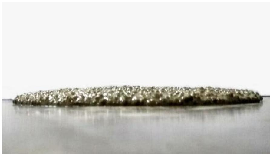
**Figura 4.1 – Consistência da argamassa leve com poliestireno expandido, vista lateralmente.**
