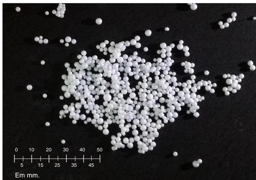
**Figura 3.3 - Pérolas de poliestireno expandido usadas no programa experimental.**
