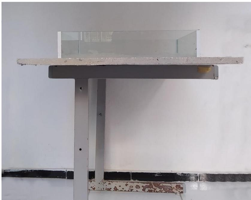
**Figura 3.10 – Esquema de realização do teste de permeabilidade de água, conforme a NBR 15498 (ABNT, 2016).**
