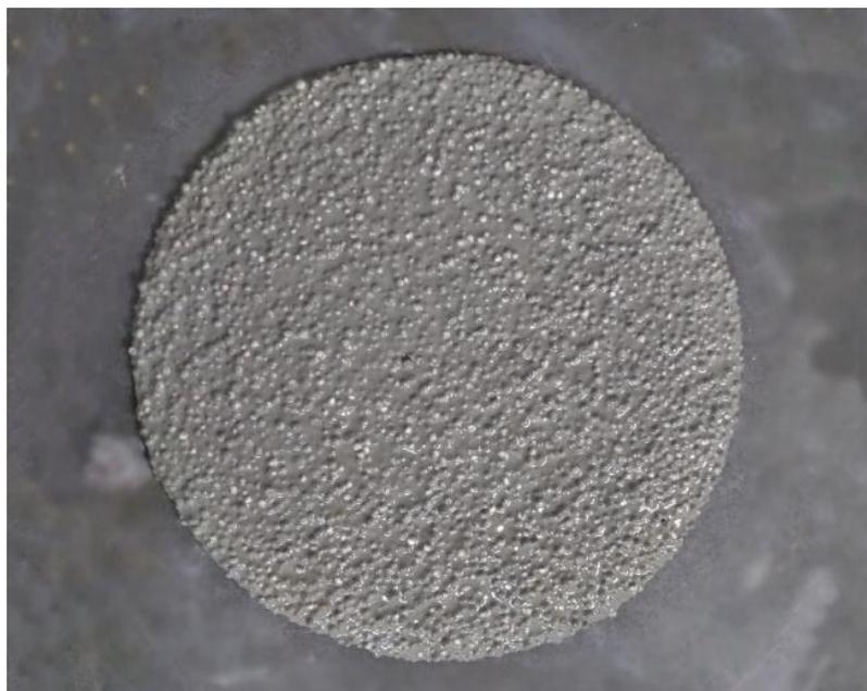
**Figura 4.2 – Consistência da argamassa leve com poliestireno expandido ( $A_{30EPS}$ ), com visão superior**
