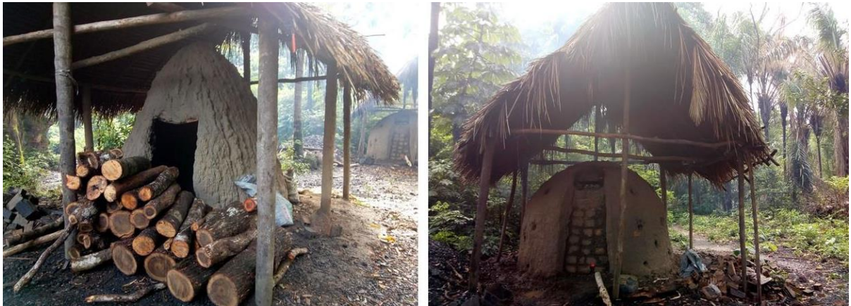
Figura 12 – Forno usado na fabricação de carvão pelas famílias quilombolas.
