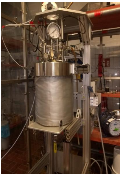
Figura 14 - Reator de aço inoxidável com tanque agitado em escala piloto de 18,925 L (Parr, EUA, Modelo: 4555).
