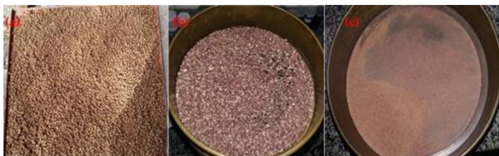
Figura 13 – Amostras obtidas após secagem, moagem e peneiramento dos caroços de Açaí [caroços + Fibras (a); caroços cominuídos + Fibras (b); e caroços Peneirados (c)].
