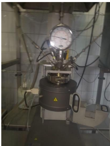
Figura 15 - Reator de aço inoxidável na escala piloto de 1,0 L (Parr, EUA, Modelo: 4577).
