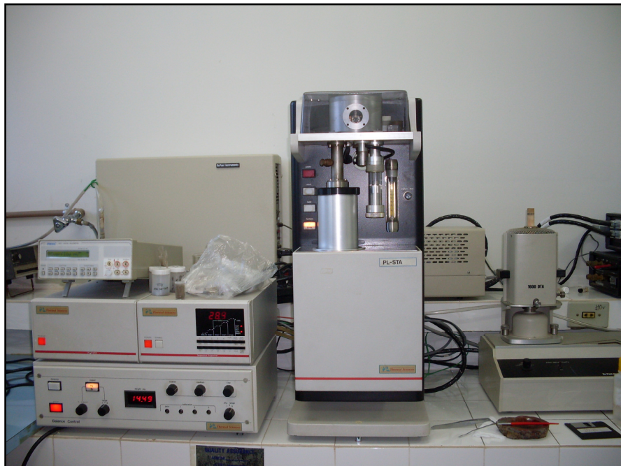
Figura 8: Termoanalisador Stanton Redcroft. Fonte: Sheila Santos
