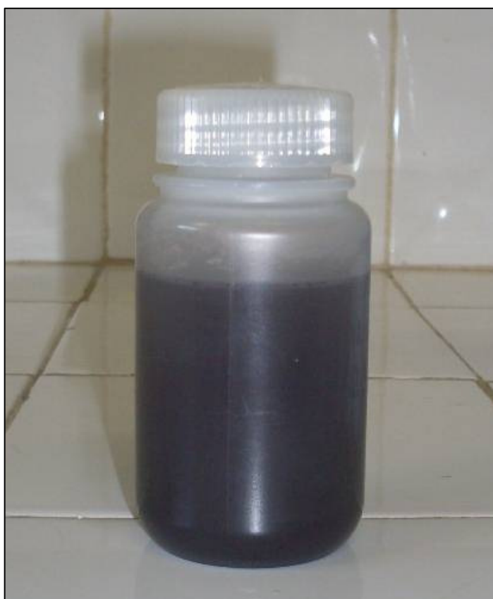
Figura 4: Mudança na coloração da solução após o tratamento hidrotérmico (de azul claro para cinza escuro).
