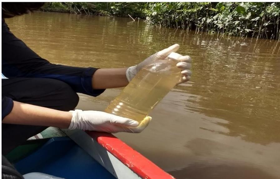
Figura 3.15 - Coleta de Amostras de DBO e DQO.
