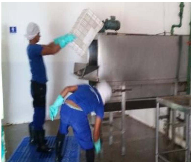
Figura 3.8 - Entrada do túnel de lavagem.
