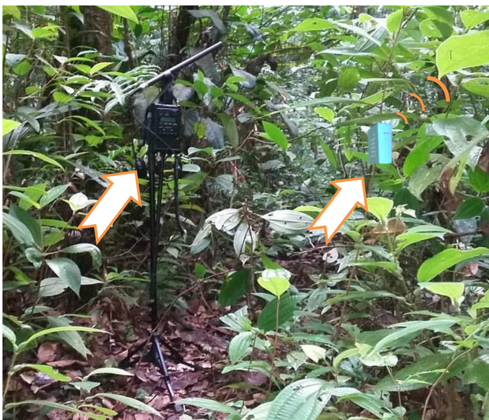
Figura 11. Esquema da montagem do set experimental, indicando o tripé com o microfone e o gravador (à esquerda) e a fonte de som (PB).
