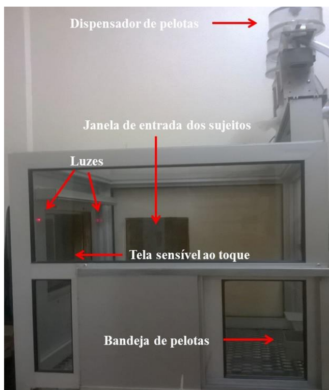
Figura 3. Câmara experimental com um monitor com tela sensível ao toque e dispensadores de pelotas.
