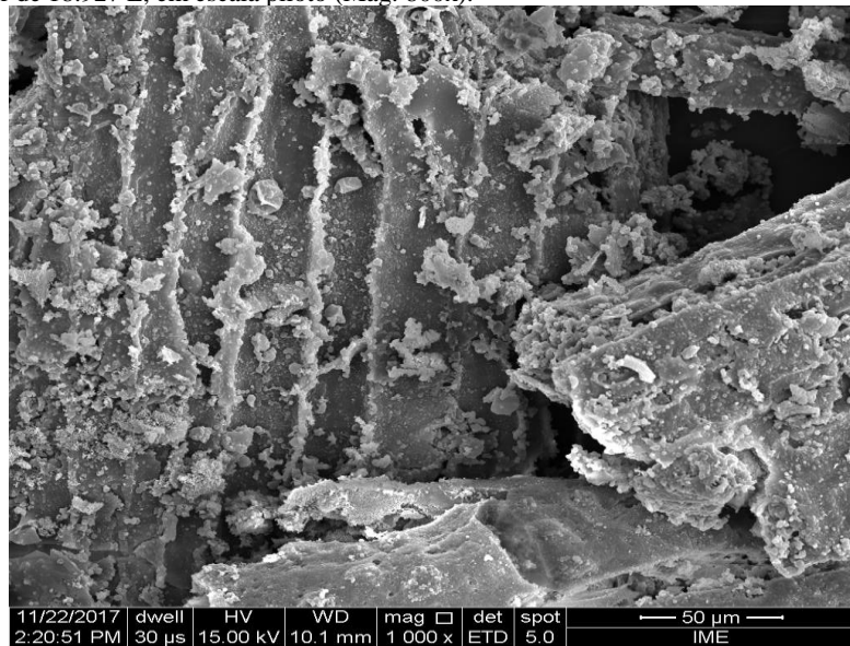
Figura B4: MEV do hidro carvão obtido via carbonização hidrotérmica de resíduos de palha e milho a 175 °C, tempo de reação de 240 minutos, razão biomassa/H 2 O de 1:10, usando um reator de 18.927 L, em escala piloto (Mag: 1000x).
