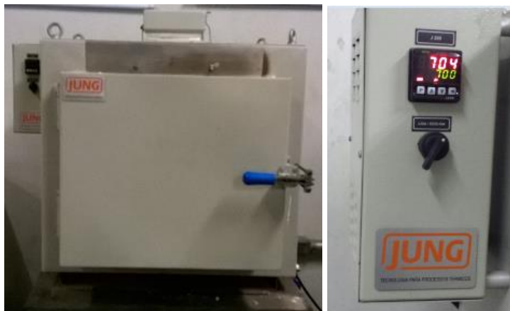
Figura 3.4 – Forno Mufla onde foi realizada a fundição. Fonte: Acervo do autor do trabalho.
