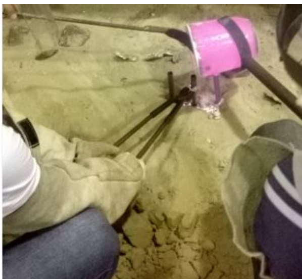
Figura 3.7 – Vazamento do alumínio líquido no molde. Fonte: Acervo do autor do trabalho.
