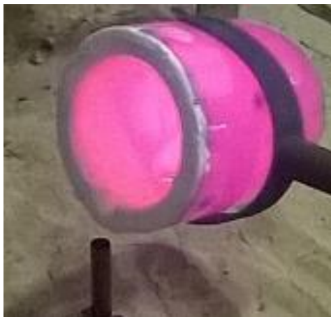
Figura 3.6 – Início do vazamento do metal líquido no molde. Fonte: Acervo do autor do trabalho.
