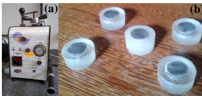
Figura 3.9 – Embutimento (a) e amostras embutidos com resina (b). Fonte: Acervo do autor do trabalho.
