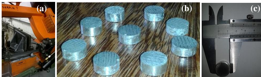
Figura 3.8 - Serra de fita (a); Amostras de alumínio (b); Diâmetro das amostras (c). Fonte: Acervo do autor do trabalho.
