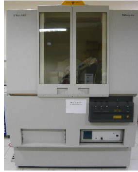
Figura 3.16 – Difratorômetro Panalytical onde foi realizado o DRX das amostras. Fonte: Acervo do autor do trabalho.
