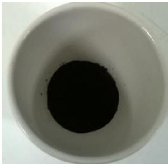
Figura 3.15 – Cadinho com NTCs usado na solubilização. Fonte: Acervo do autor do trabalho.
