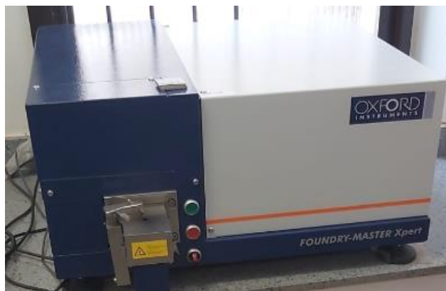
Figura 3.11 – Espectrometro de emissão atômica OXFORD. Fonte: Acervo do autor do trabalho.
