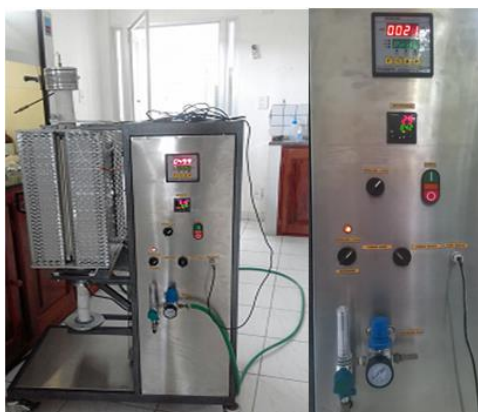
Figura 3.14 – Forno FORTLAB onde foi realizada a solubilização. Fonte: Acervo do autor do trabalho.
