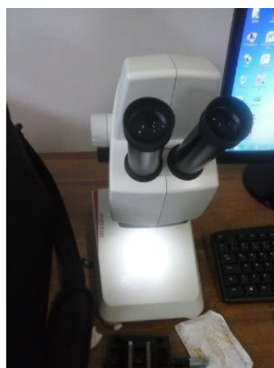
Figura 3.13 – Microscópio estereoscópio para avaliação dos grãos. Fonte: Acervo do autor do trabalho.
