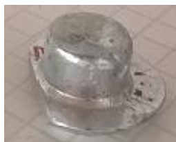
Figura 3.2 – Peças de Alumínio comercialmente puro para obtenção das amostras. Fonte: Acervo do autor do trabalho.
