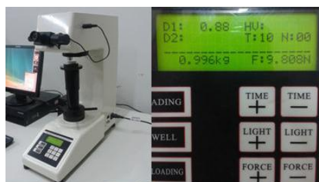
Figura 3.17 – Avaliação da Microdureza Vickers das amostras no Microdurômetro. Fonte: Acervo do autor do trabalho.
