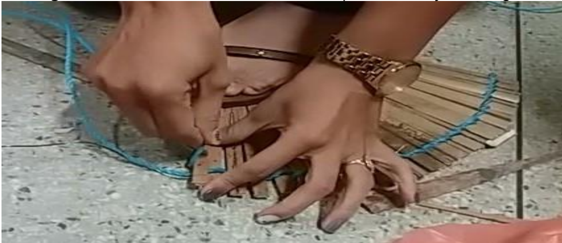
Figura 43 - Tecimento com náilon de 3mm para a formação da língua
