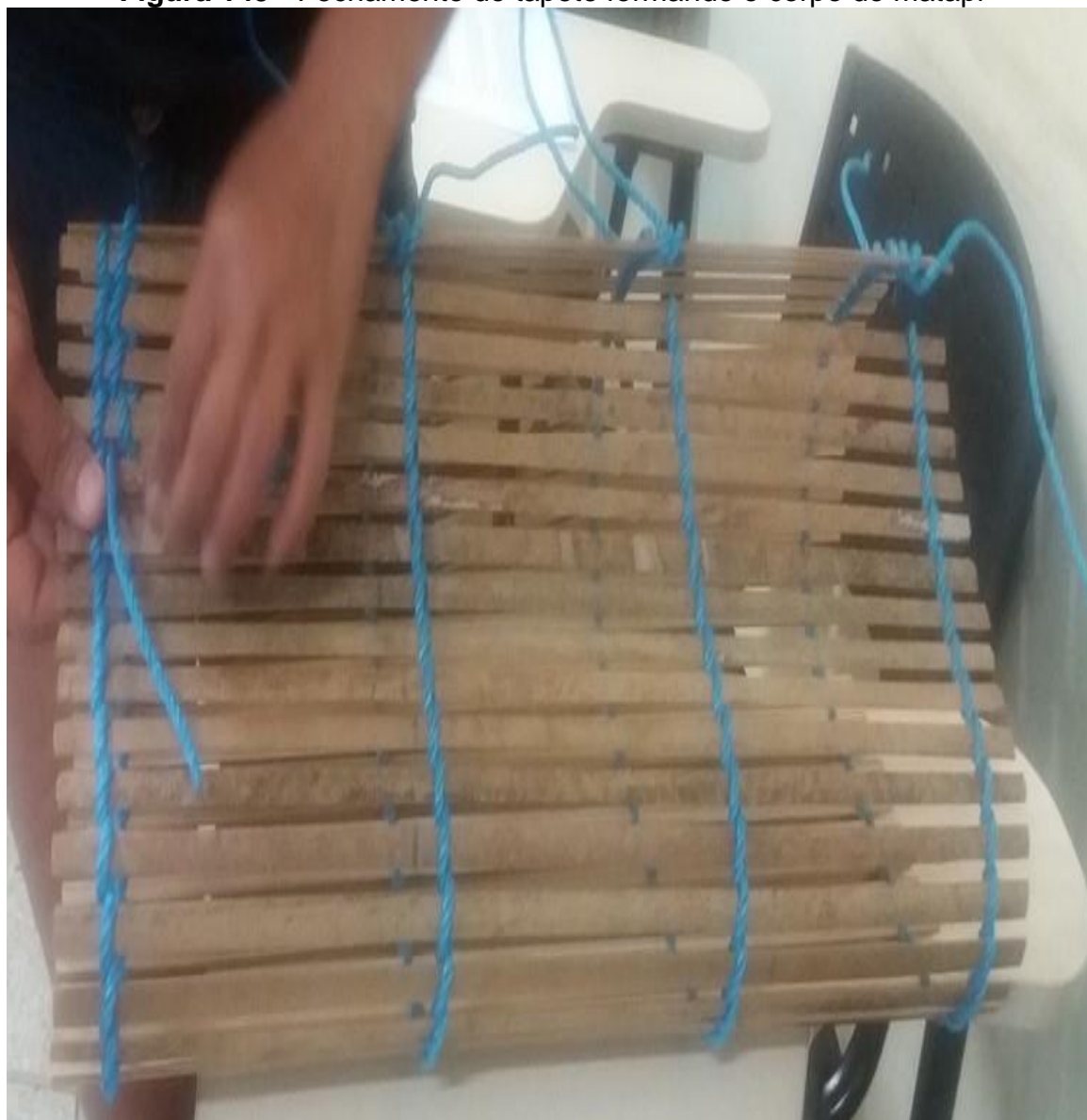
Figura 149 - Fechamento do tapete formando o corpo do matapi
