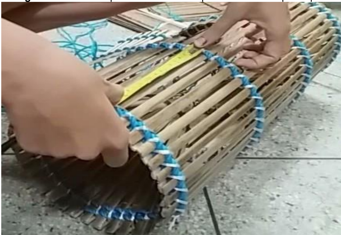
Figura 147 - Medida para cada uma das quatro divisões do pari-tapete
