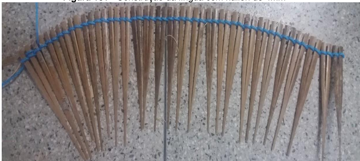
Figura 151 - Construção da língua com náilon de 4mm
