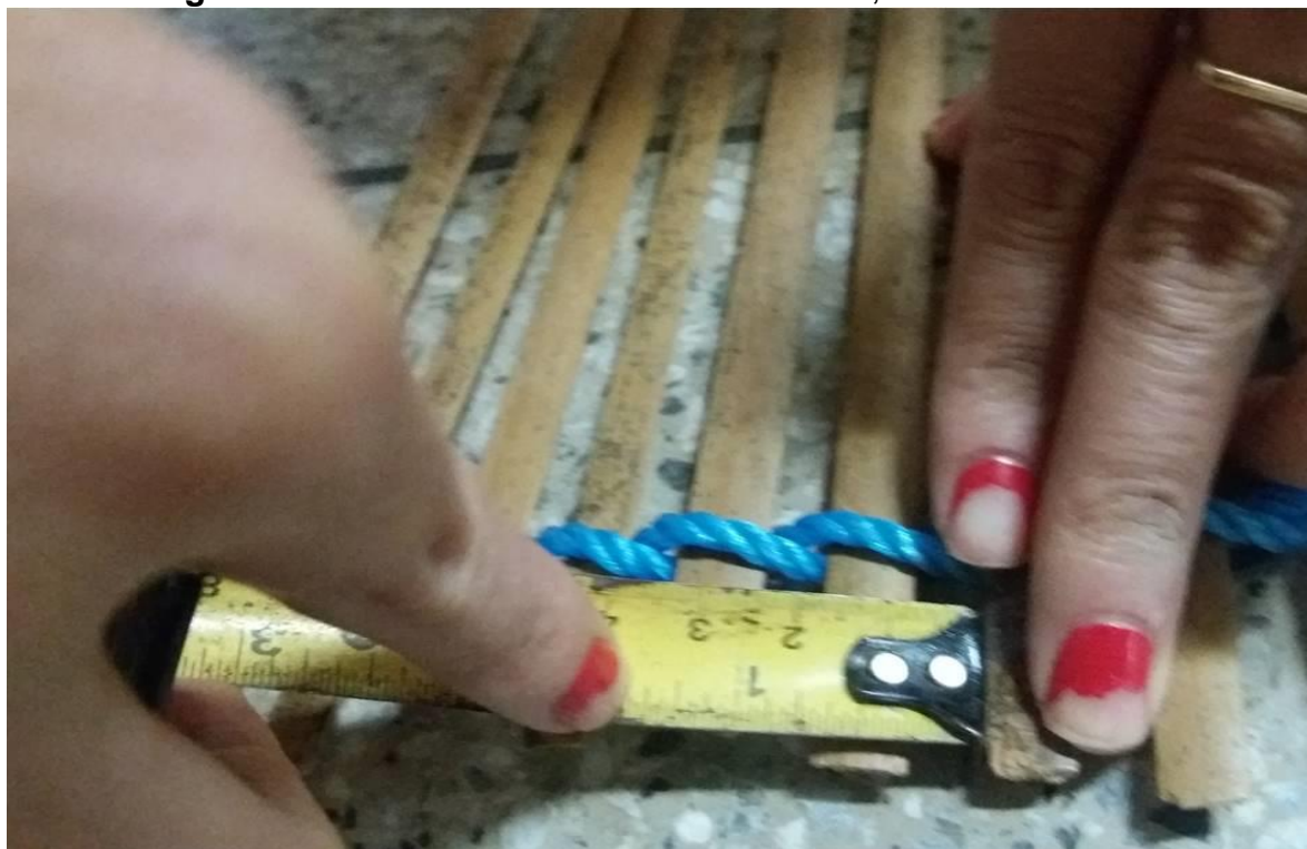
Figura 112 - Distância entre as talas de 5mm, fio de náilon 4mm
