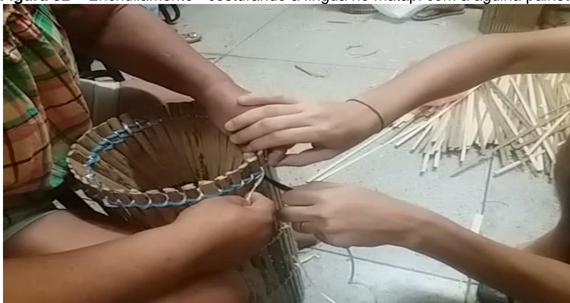
Figura 52 – Enchuliamento - costurando a língua no matapi com a agulha palheta
