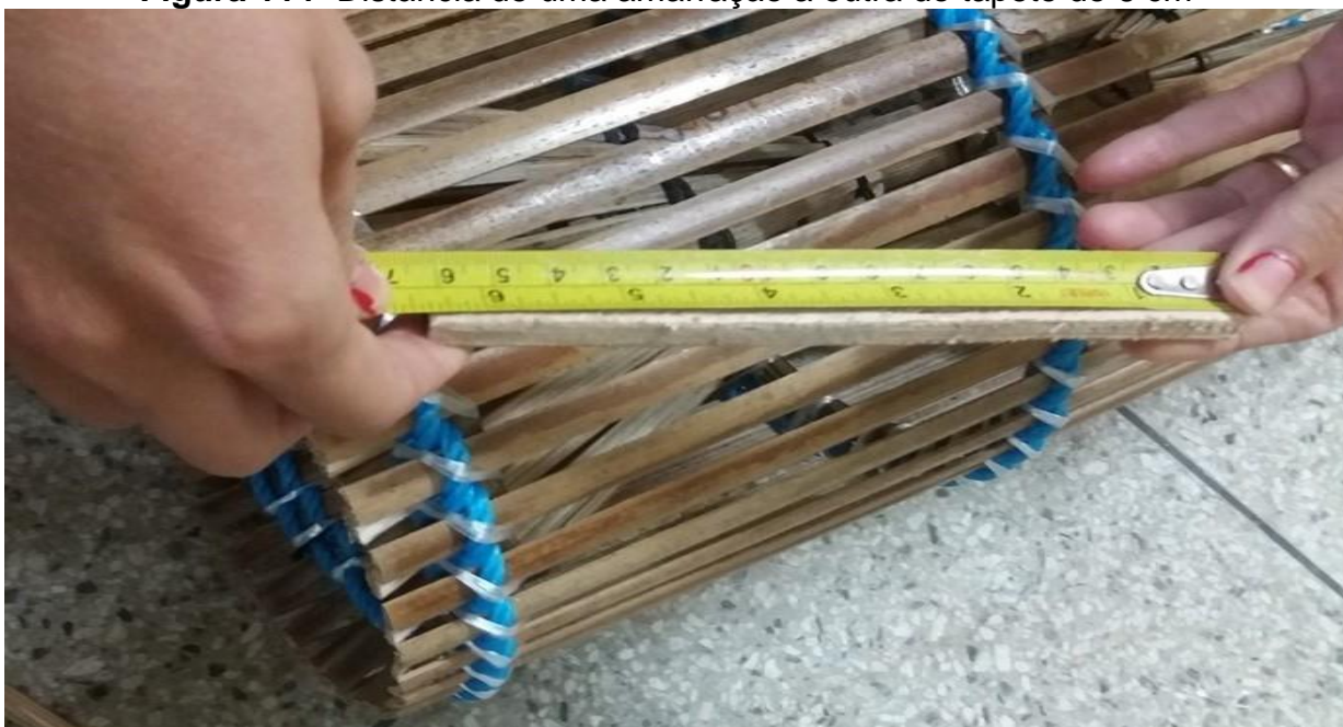
Figura 114- Distância de uma amarração a outra do tapete de 6 cm
