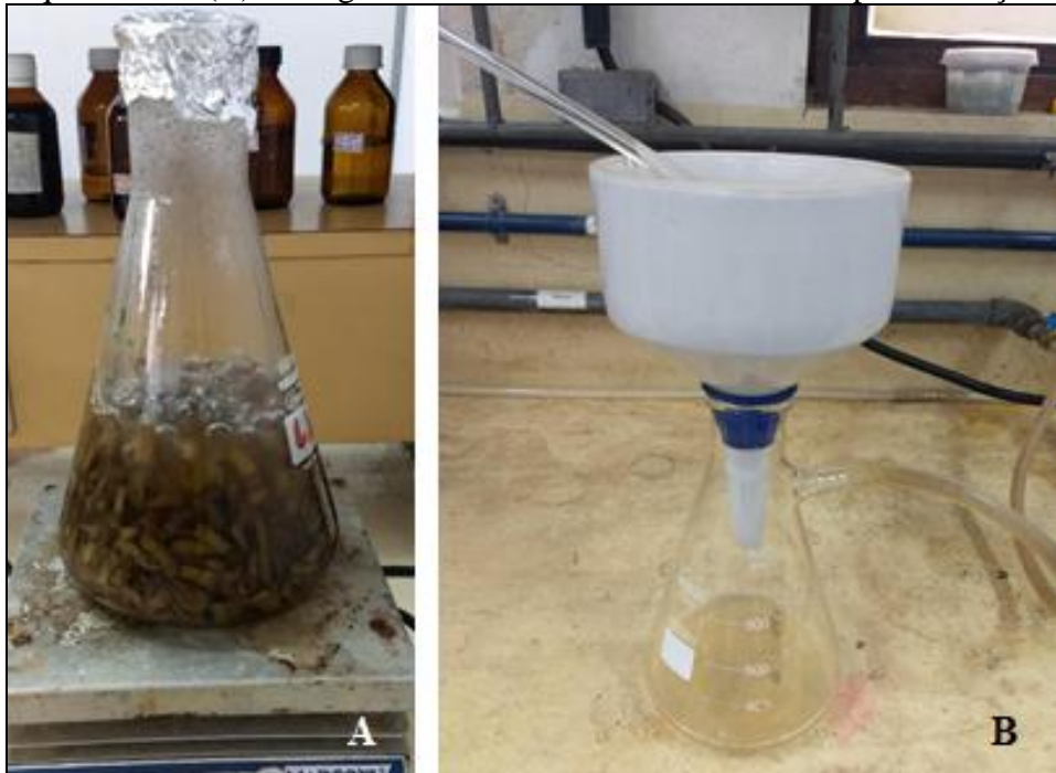
Figura 11 – Decocção e filtragem do extrato da casca da banana. (A) Decocção em chapa aquecedora. (B) Filtragem do extrato da casca da banana após decocção.
