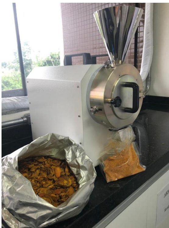
Figura 8 - Moinho de facas (Modelo Tipo Willey -SL-31, Fabricante SOLAB, Brasil)
