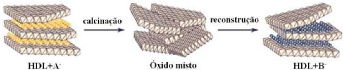
Figura 3 - Representação esquemática do processo de reconstrução do HDL, o "efeito memória". Fonte: Vieira (2009).
