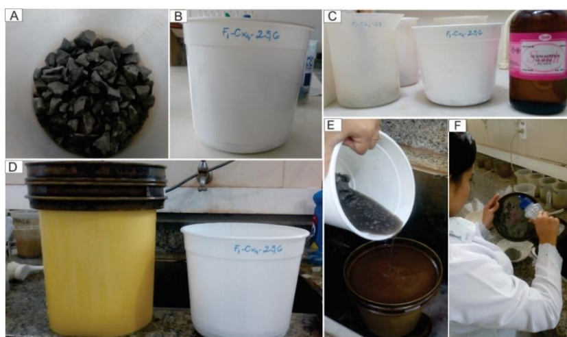
Figura 2- Etapas do método. A) Amostras desagregadas fisicamente. B) Balde plástico onde amostras são armazenadas. C) Amostras com ácido acético, inseridas na capela de exaustão. D) Peneiras e baldes utilizados para a lavagem do material. E) Lavagem do material com retenção do resíduo líquido em um recipiente para posterior descarte adequado. F) Armazenamento do material lavado em cápsulas de porcelana.
