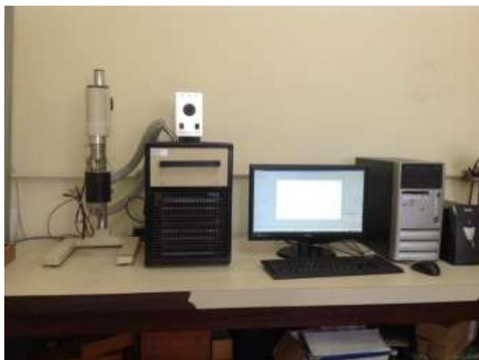
**Figura 3.4.** Viscosímetro rotacional modelo Haake VT 550
