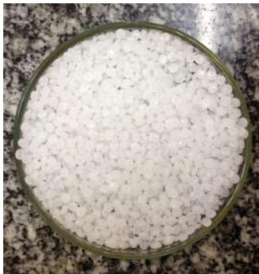
**Figura 3.1** Partículas de PEBD utilizadas como inertes
