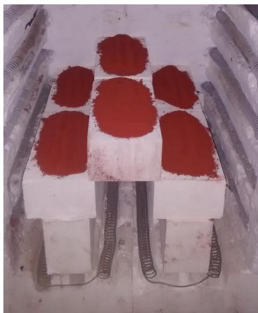
Figura 22: Lama vermelha pré-calcinada.
