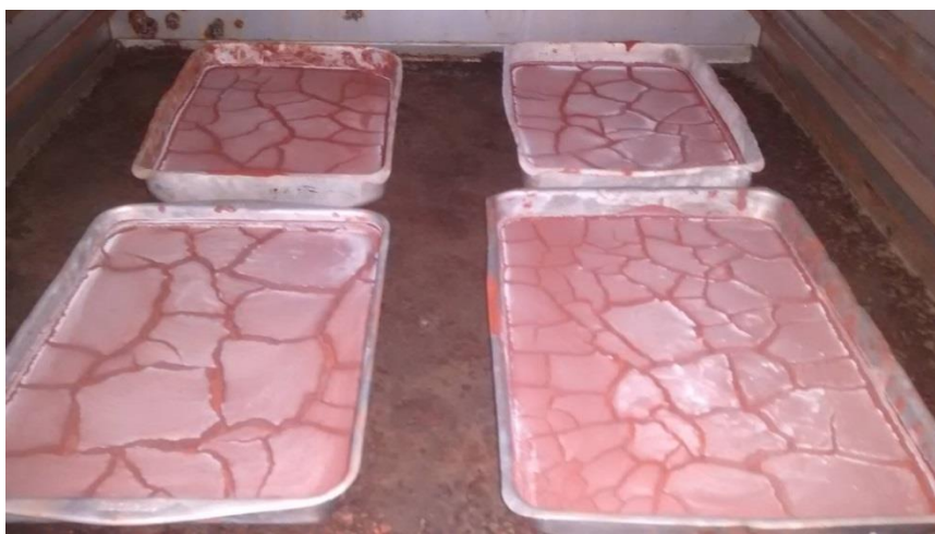
Figura 20: Desidratação da lama vermelha ativada quimicamente.
