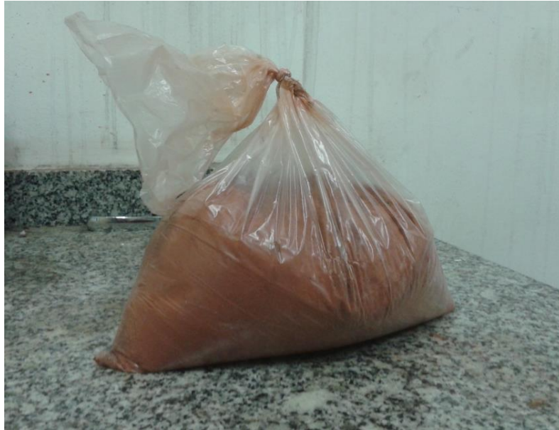
Figura 15: Ensacamento da lama vermelha cominuida.
