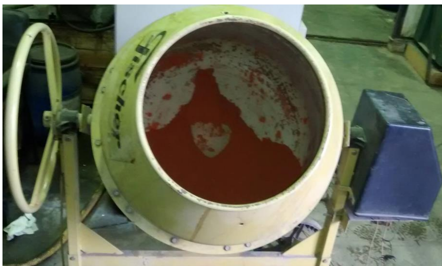
Figura 16: Betoneira com lama vermelha em solução de HCl.
