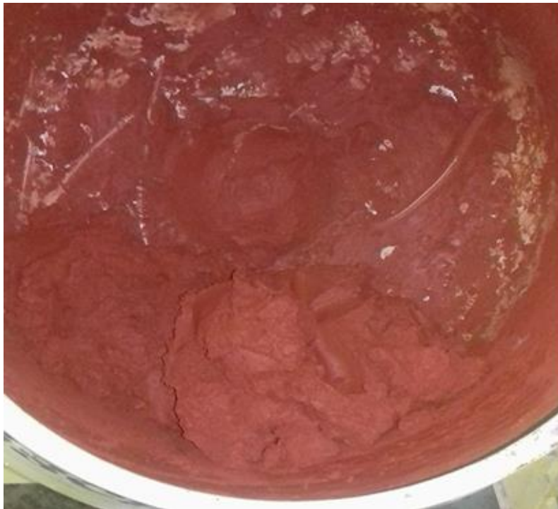
Figura 19: Mistura sólida da lama vermelha com solução 2 molares de HCl.
