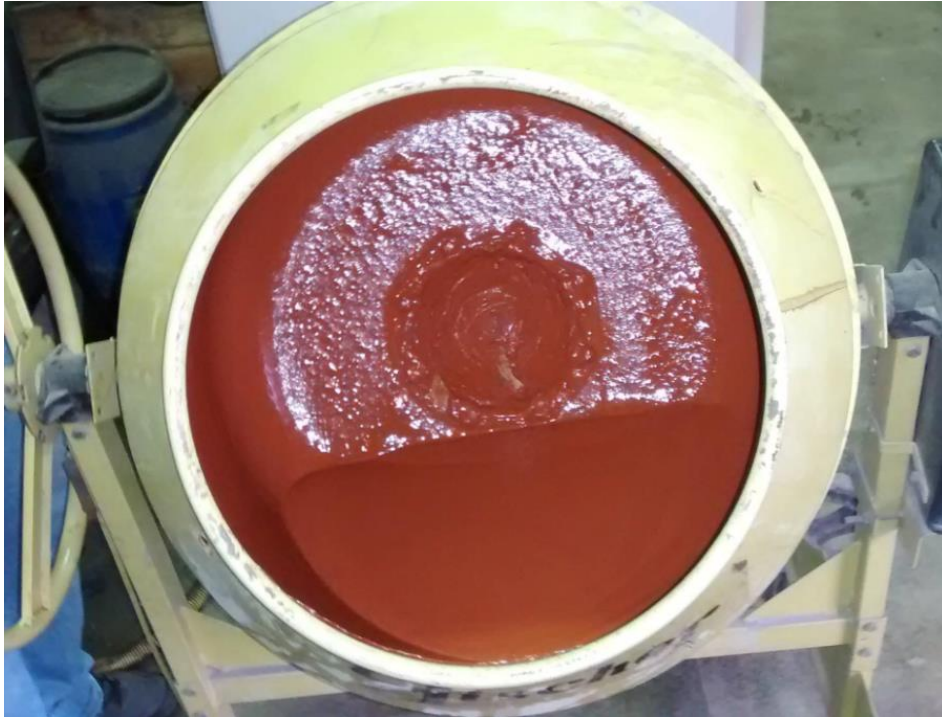
Figura 18: Mistura homogeneizada (Lama vermelha + HCl).
