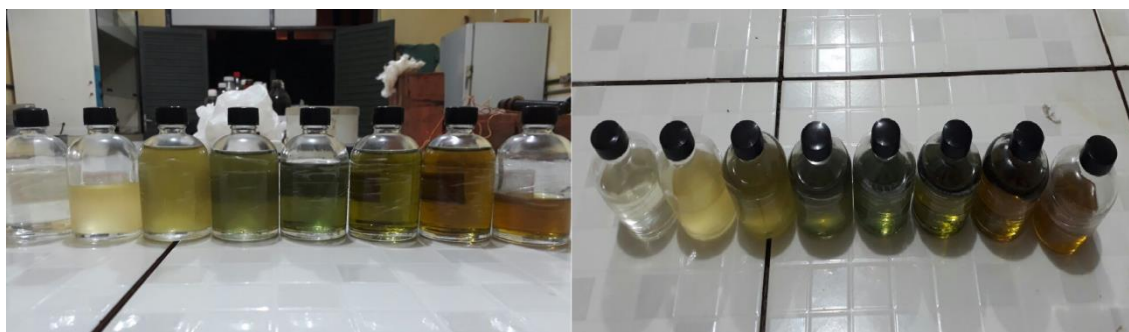
Figura 33: Frações de biocombustíveis destilados (Gasolina, Querosene, Diesel leve e Diesel pesado).
