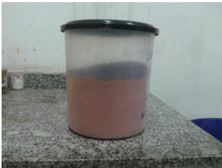
Figura 21: Armazenamento da lama vermelha ativada quimicamente.
