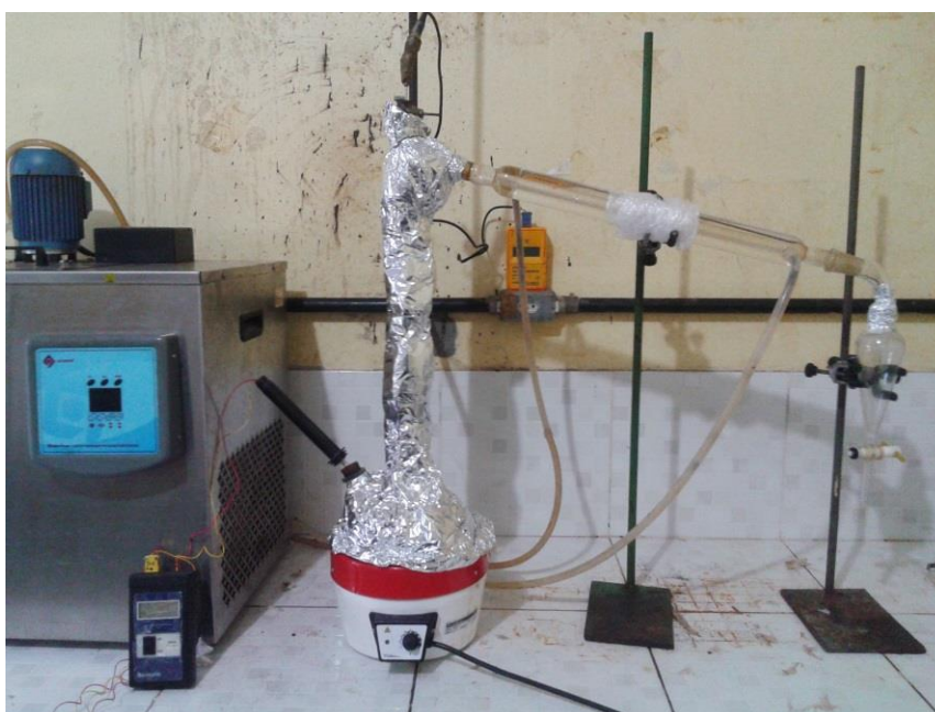
Figura 32: Aparato de destilação em escala de bancada no laboratório de processos de separações térmicas (THERMTEK).
