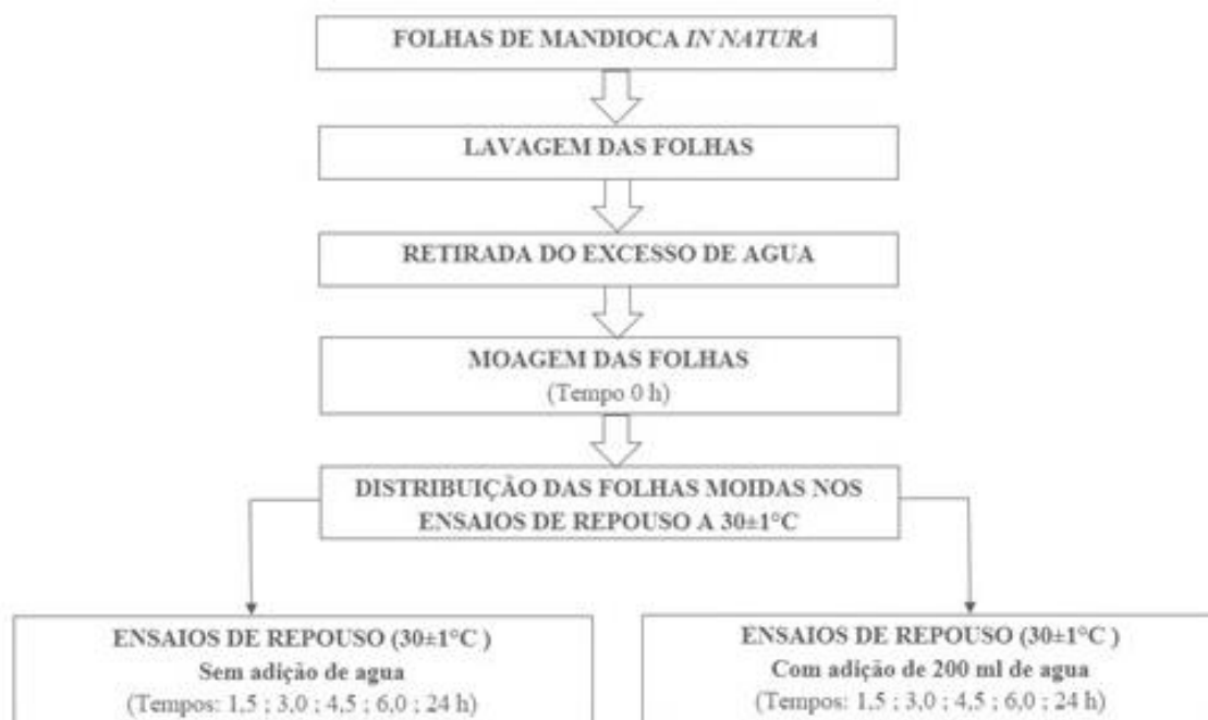
Figura 1. Fluxograma das etapas dos ensaios de repouso para folhas de mandioca moídas sem e com adição de água.
