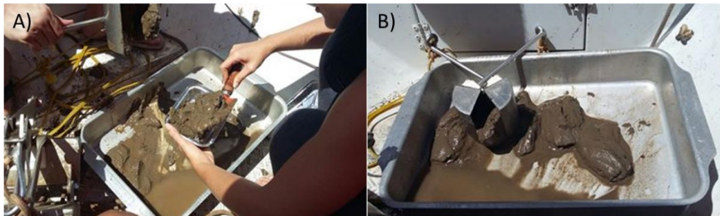
Figura 7 - Equipamentos usados na amostragem: a) Recipientes metálicos e b) Draga Van Veen.
