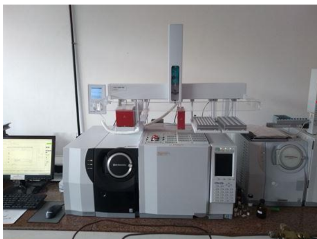
Figura 8 - Cromatógrafo gasoso GCMS-TQ8040 – Shimadzu empregado na análise dos esteróis.
