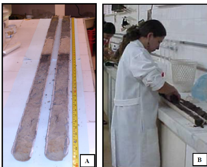
FIGURA 7 – A: Testemunho de sub-superfície logo após a sua abertura, visualização perfeita das camadas de sedimentação. B: Retirada das amostras de sedimentos dos testemunhos de sub-superfície. Fotos: Lamarka Lopes Pereira, 2006.
