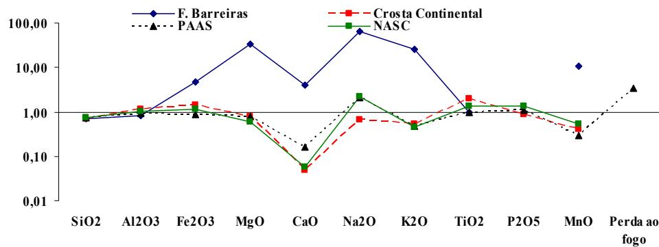
**Figura 14** - Normalização das concentrações dos elementos maiores em forma de óxidos ( $\text{SiO}_2$ ,  $\text{Al}_2\text{O}_3$ ,  $\text{Fe}_2\text{O}_3$ ,  $\text{MgO}$ ,  $\text{CaO}$ ,  $\text{Na}_2\text{O}$ ,  $\text{K}_2\text{O}$ ,  $\text{TiO}_2$ ,  $\text{P}_2\text{O}_5$  e  $\text{MnO}$ ) nas transecções (T1 e T2) em relação à CTS Taylor & McLennan (1985); Padrões PASS Taylor & McLennan (1985); NASC Gromet et al.. (1984) e Formação Barreiras Berrêdo (2006).
