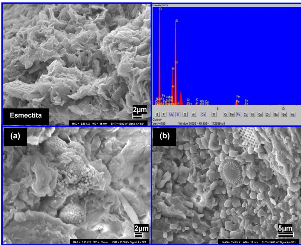
**Figura 10** - Fotomicrografias obtidas por MEV de argilomineral de esmectita e frambóides de pirita (a), e com minerais de halita e diatomácea (b) encontrados nos sedimentos de manguezal de Bragança.
