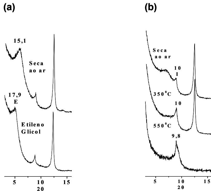
**Figura 13** – Difração de raios-X da fração argila dos sedimentos de mangue de Bragança após saturação com  $MgCl_2$  (a) e com  $KCl$  (b).
