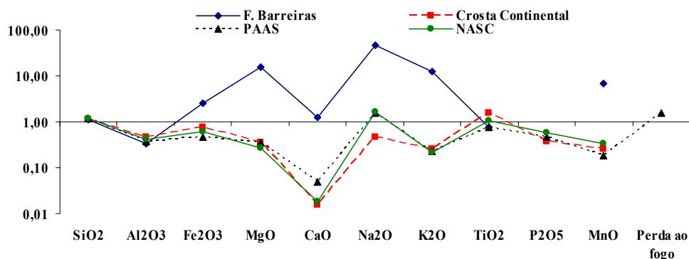
**Figura 15** - Normalização das concentrações dos elementos maiores em forma de óxidos (SiO<sub>2</sub>, Al<sub>2</sub>O<sub>3</sub>, Fe<sub>2</sub>O<sub>3</sub>, MgO, CaO, Na<sub>2</sub>O, K<sub>2</sub>O, TiO<sub>2</sub>, P<sub>2</sub>O<sub>5</sub> e MnO) em PHb em relação à CTS (Taylor & Mclennan 1985); Padrões PASS (Taylor & Mclennan 1985); NASC (Gromet et al.. 1984) e Formação Barreiras (Berrêdo 2006).
