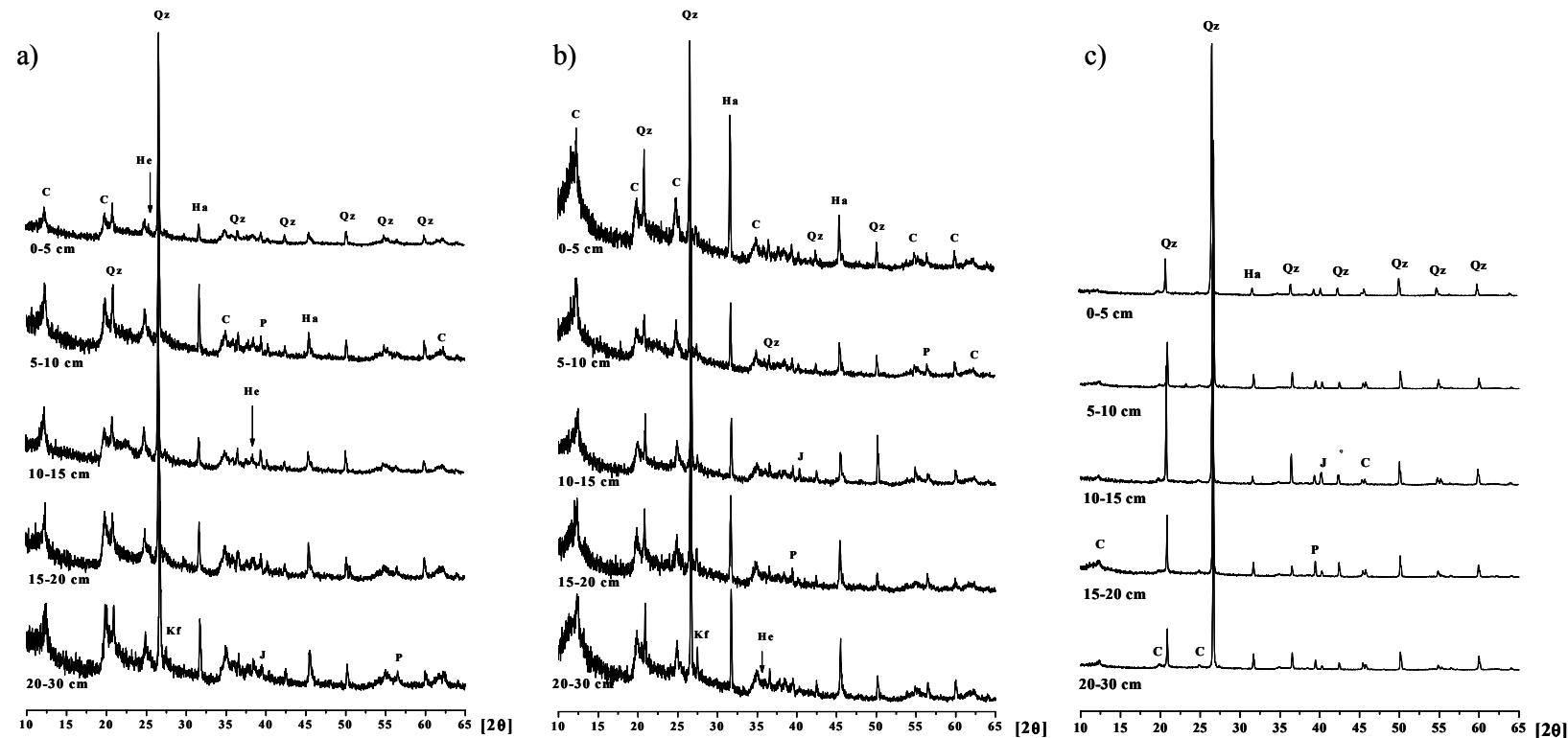
Figura 7 - Difratograma de raios-x em amostras totais nos sedimento do manguezal de Bragança,: T1 (a), T2 (b) e Platô herbáceo (c), mostrando seus principais minerais: C-caulinita, Qz-quartzo, He-hematita, Kf-K-feldspato, P-pirita, J-jarosita, e Ha-halita; PHb: C-caulinita, Qz-quartzo, P-pirita, J-jarosita, e Ha-halita.
