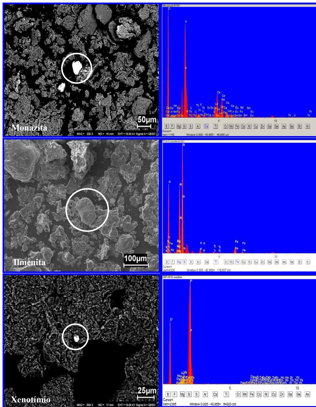
**Figura 8** - Fotomicrografias obtidas por microscopia eletrônica de varredura (MEV) de minerais encontrados nos sedimentos de manguezal de Bragança.
