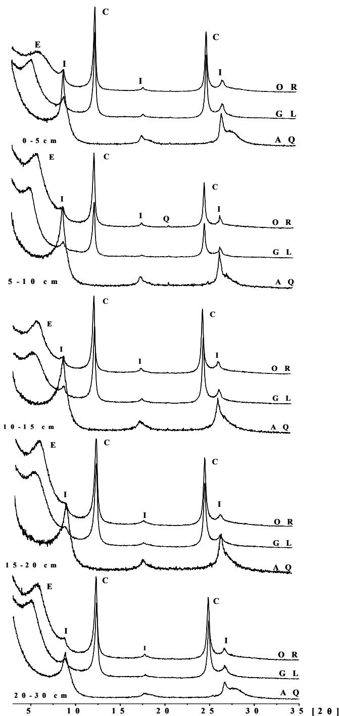
**Figura 12** - Difração de raios-X dos argilominerais presentes nos sedimentos do manguezal de Bragança (0-30 cm). Esmectita (E), Caulinita (C) e Ilita (I) em (T1), (T2) e (PHb). Lâminas orientadas (OR), solvatadas com etileno glicol (ELG) e aquecidas a 550º C (AQ).
