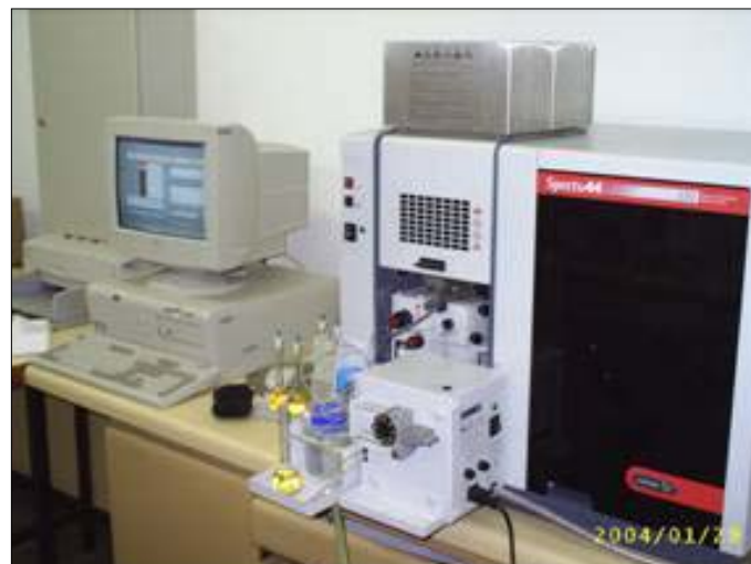
Figura 18 – Espectrômetro de absorção atômica marca Varian 220-VGA77 com gerador de hidretos do Instituto Evandro Chagas, em Belém-PA, empregado nas análises de As e Se.
