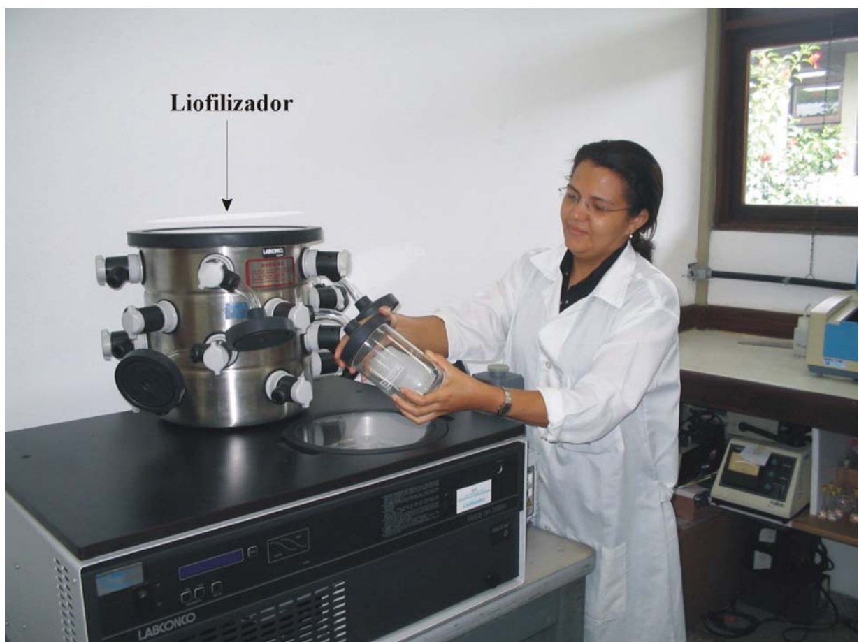
Figura 23 – Imagem do liofilizador Freezone 6 N/S (Labconco) do Museu Paraense Emílio Goeldi.
