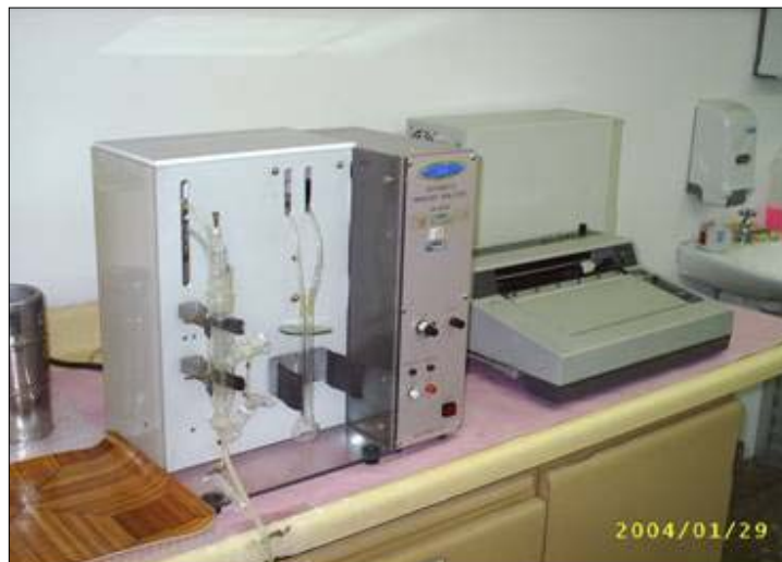
Figura 17 – Espectrômetro de absorção atômica marca HG- 3500 modelo K.K SANSO S.S com gerador de vapor frio do Instituto Evandro Chagas, em Belém-PA empregado na análise de Hg.
