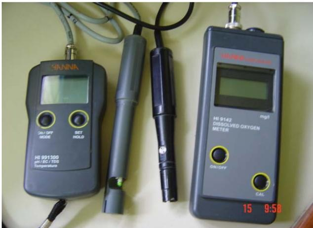
Figura 12 - Potenciômetros portáteis utilizados in situ.
