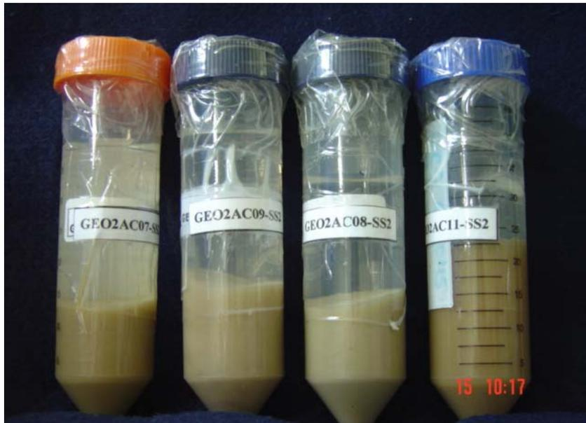
Figura 10 - Sedimentos em suspensão (suspensatos) em frascos cônicos após floculação com sulfato de alumínio.
