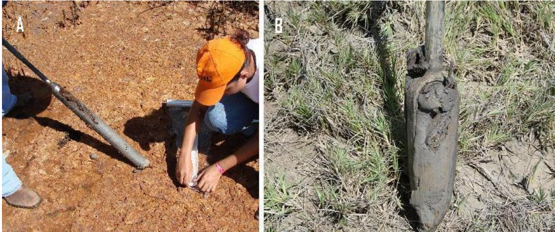
Figura 10 – (A) Testemunhador semi-cilíndrico de aço-carbono, utilizado em amostragens de sedimentos; (B) Trado Holandês.
