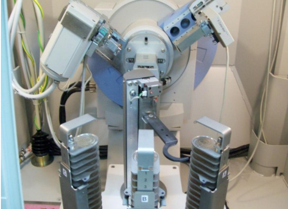
Figura 13 - Imagem do Goniômetro do Difratorômetro de Raios-x PANalytical, modelo X-PERT PRO MDP (PW 3040/60).
