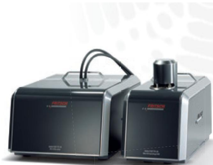
Figura 12 - Granulômetro da marca Fritsch, modelo ANALYSETTE 22 MICROTEC PLUS, realiza leituras de frações até 2 mm.
