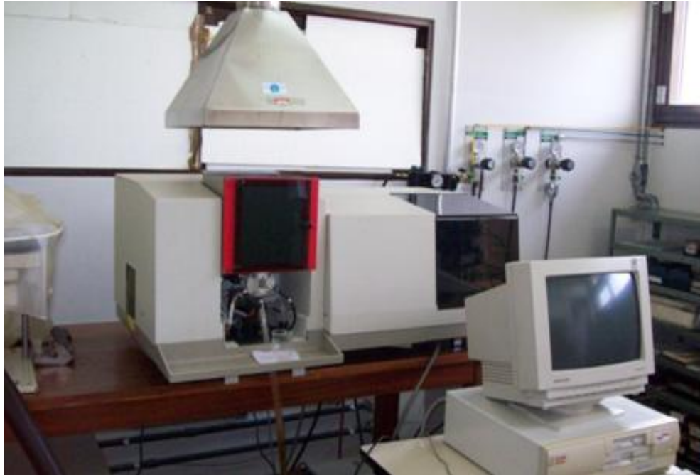
Figura 16. Espectrômetro de Absorção Atômica utilizado na leitura da concentração dos elementos maiores e traço.
