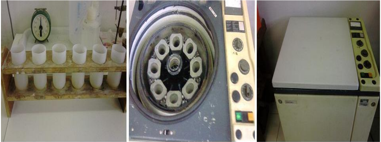
Figura 11 – Tubos de polietileno, parte interna e externa da centrífuga Heraeus Christ.
