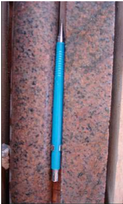
Figura 8: Foto de testemunho de sondagem do granito Palito.
