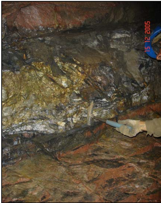
Figura 11: Foto de veio de quartzo mineralizado com sulfetos do depósito Palito (interior de galeria subterrânea).
