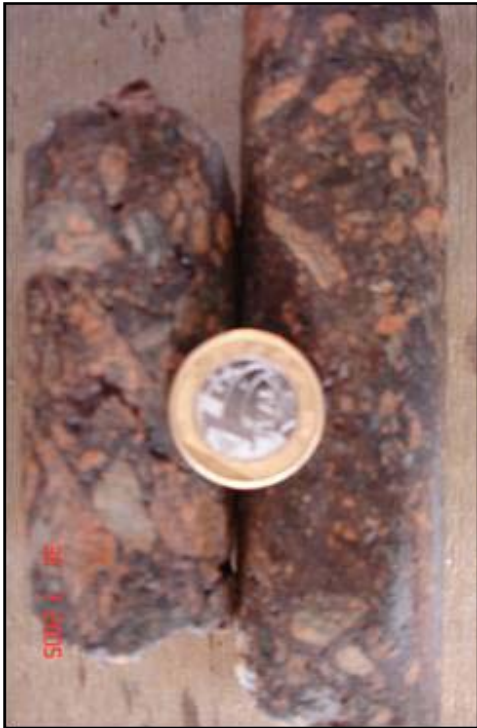
Figura 14: Foto de testemunho de sondagem composto de brecha hidrotermal.
