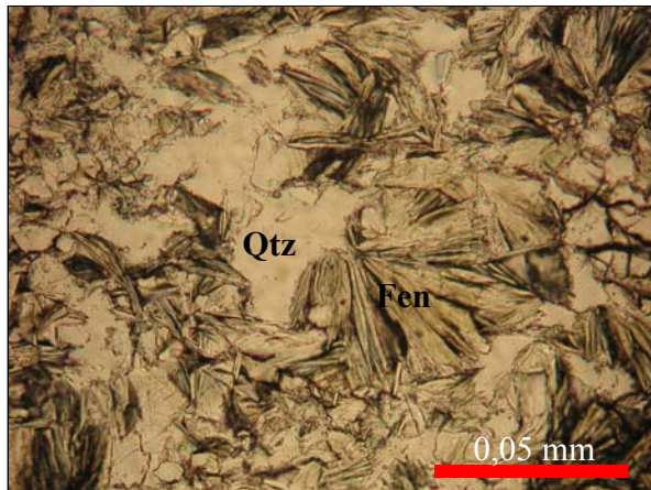
Figura 38: Fotomicrografia de cristais laminares radiados de fengita (20X-LT, NP).
