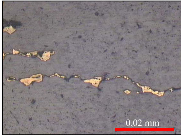
Figura 50: Fotomicrografia de vênula de calcopirita 2 em quartzo (50X-LR, NP).
