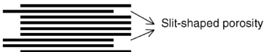
Figura 5.16 – Representação esquemática da porosidade tipo fenda nos tactóides.
