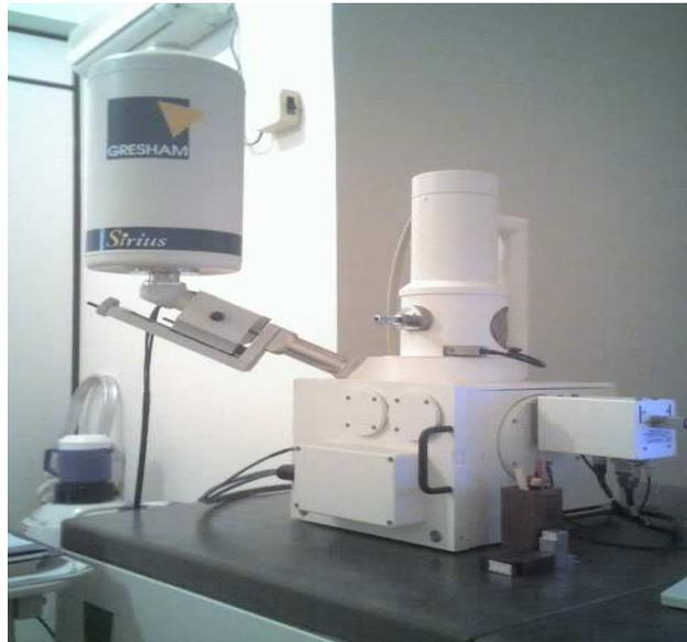
**Figura 15:** Microscópio Eletrônico de Varredura (MEV) LEO 1430.
