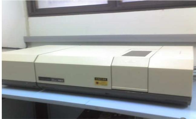
**Figura 13:** Espectrômetro de Infravermelho tipo Perkin Elmer FT-IR Spectrometer 1760y.
