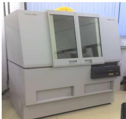
**Figura 9:** Aparelho de Difração de Raios-X do laboratório de difração de raios-X do IG.
