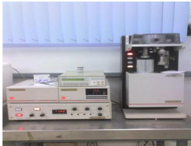
**Figura 14:** Analisador térmico simultâneo ATD – ATG marca PHILIPS.
