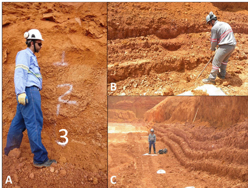
Figura 4.1 – A – Horizontes bauxíticos nas frentes de Lavra (1 – CAP, 2 – BN, 3 – BNC); B e C - Amostragem de canaletas para o controle de qualidade na frente de lavra, com a exposição do talude da próxima frente de lavra na mina.
