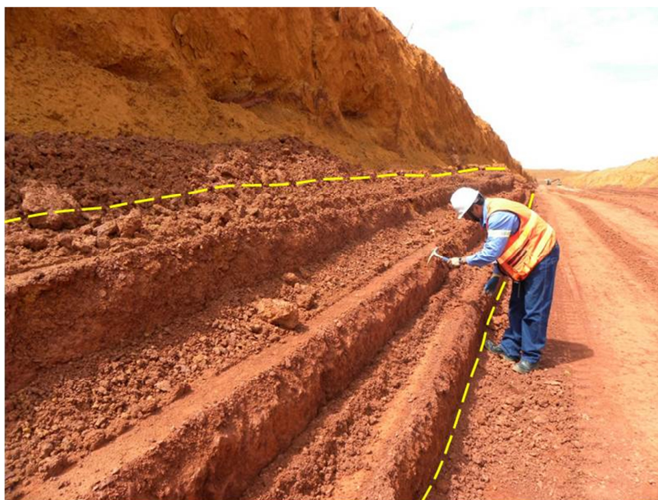
Figura 3.1 – Foto da frente de lavra da Mina-4 com exposição de um horizonte espesso de Bauxita Nodular Concrecionária delimitada pela linha tracejada em amarelo.
