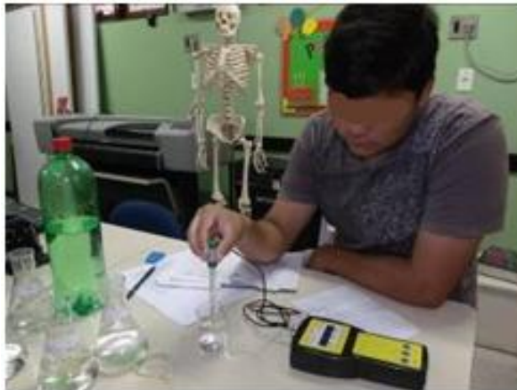
Imagem 14 – Medição de pH das amostras de água da torneira e da chuva, ano 2012.
