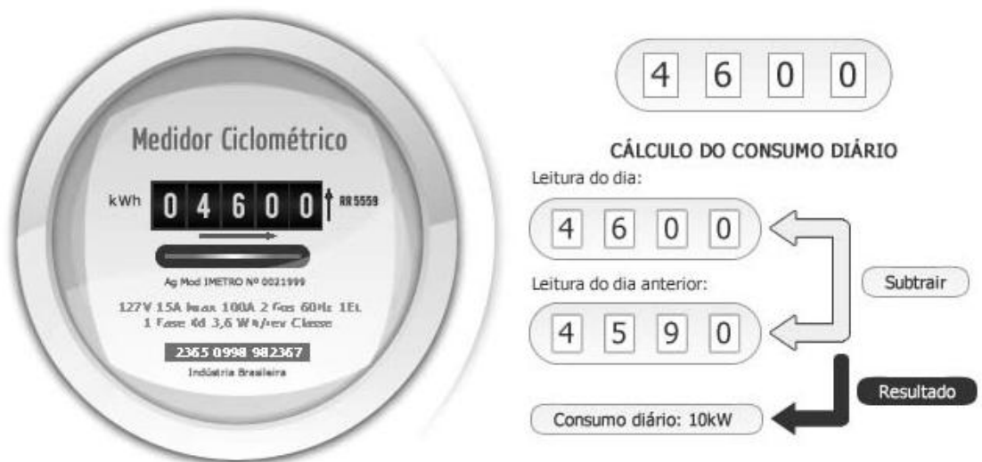
Figura 2.2 - Medidor de energia elétrica com mostrador ciclométrico. Fonte: (COELBA, 2021).
