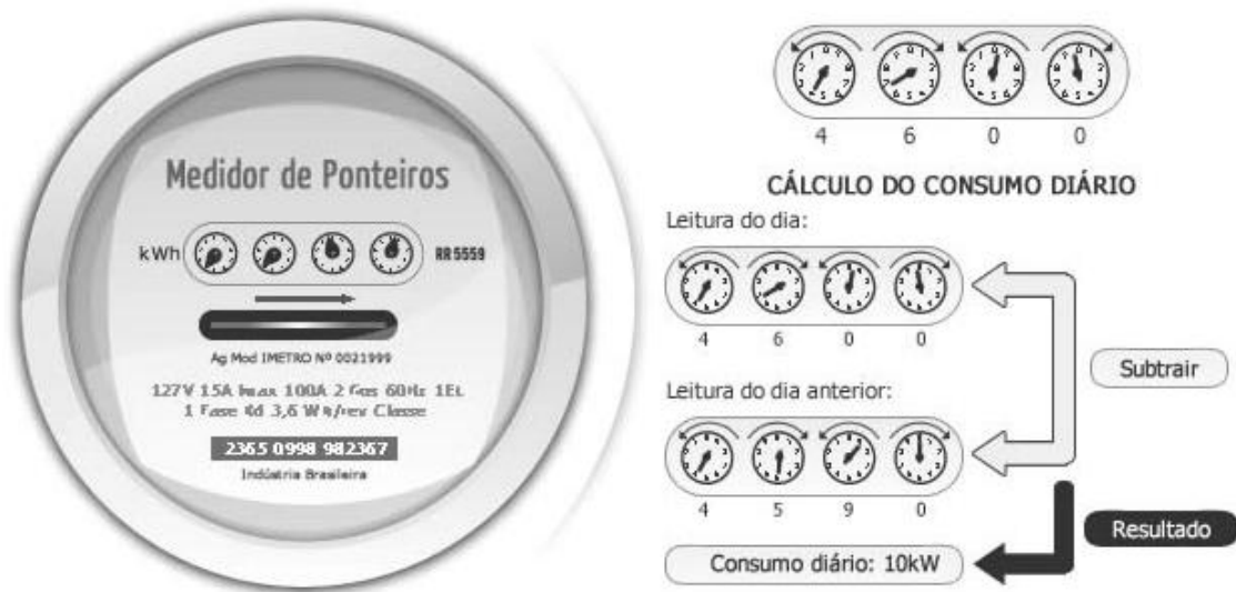
Figura 2.1 - Medidor de energia elétrica com ponteiros. Fonte: COELBA (2021).
