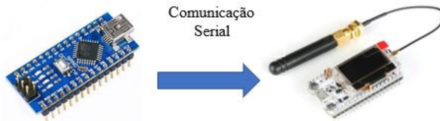
Figura 3.26 - Conexão Arduino Nano com o Arduino LoRa.
