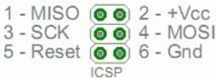
Figura 3.29 - Pinagem do barramento SPI do Arduino.
