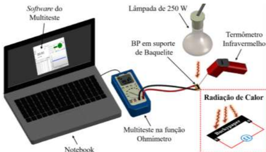
Figura 3.7 – Ilustração esquemática da medição de resistência elétrica do BP submetido ao aquecimento por uma lâmpada de 250 W em ambiente outdoor .
