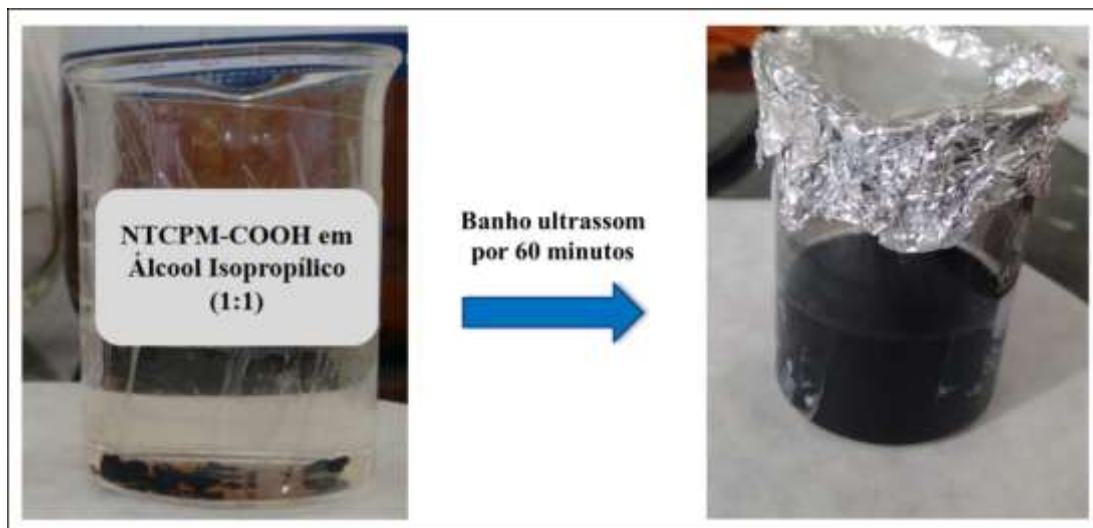
Figura 4.2 – Dispersão de NTCPMs-COOH em álcool isopropílico após 60 minutos em banho de ultrassom.
