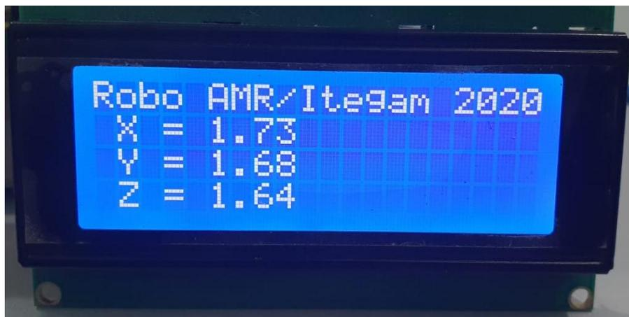
Figura 4.4 - LCD mostrando as informações obtidas do Beacon.
