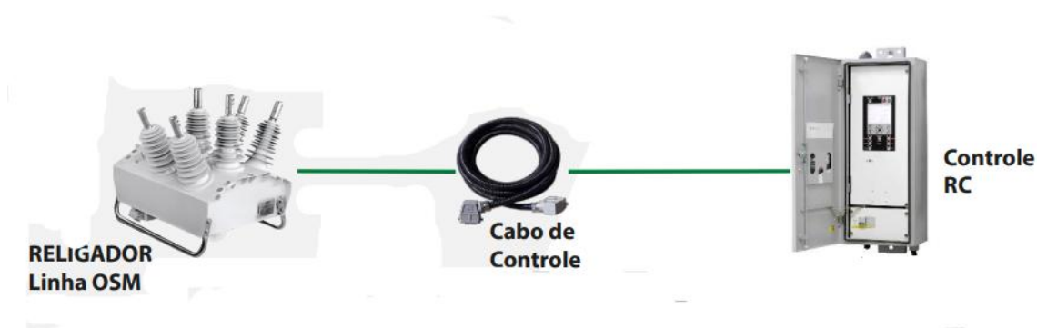
Figura 2.6 - Religador automático - ACR. Fonte: NOJA POWER (2017).
