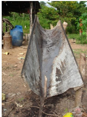
Figura 16- Equipamento (bica de zinco) utilizado para escorrer o óleo ao sol antes da padronização do processo de extração.
