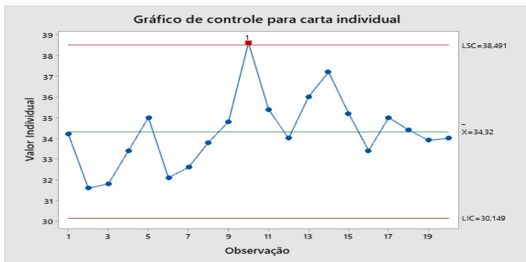
Figura 4.12 - Amostras de hastes fora de controle.
