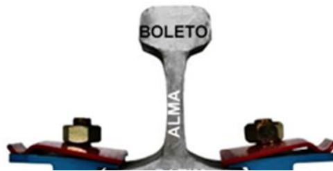
Figura 2.3 - Componentes do trilho, Vale S.A (2009)
