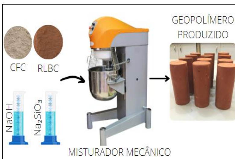
Figura 3.3 - Processo de produção dos geopolímeros.
