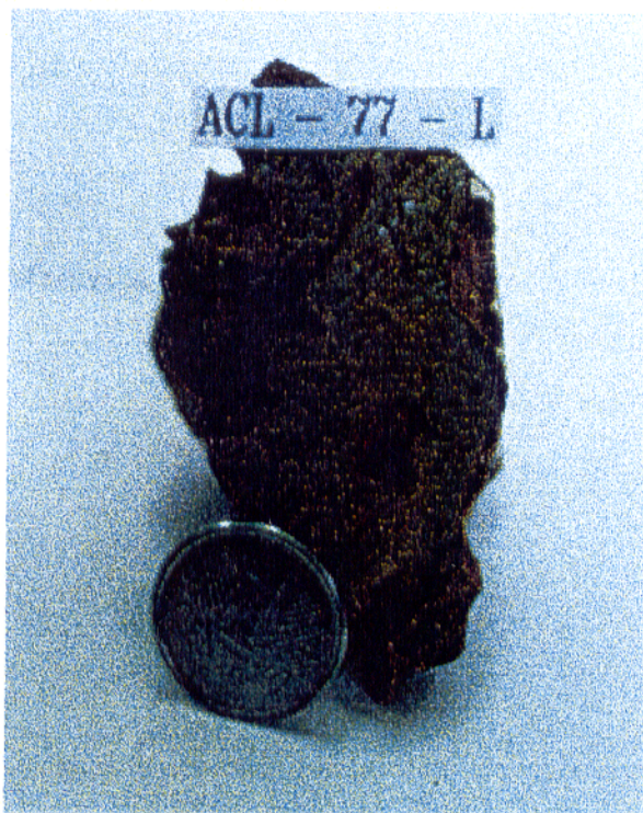
Figura 3.4 - Aspecto de fragmentos da crosta laterítica.
