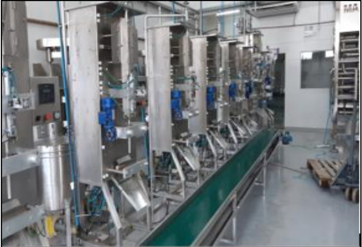
Figura 35 – Máquina de embalagem de polpa
