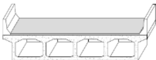
Figura 2.12A - Modelo de seção transversal multicelular. Fonte: O'BRIEN e KEOGH, 1999.
